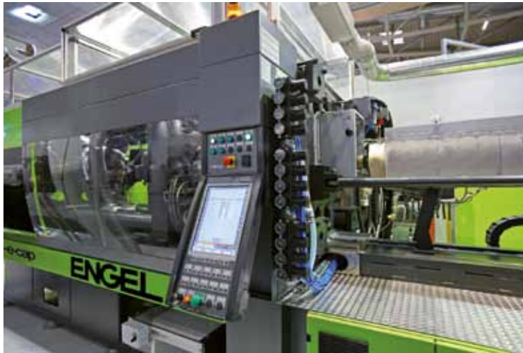
Die neue e-cap: erste vollelektrische Verschlusskappenproduktion The new e-cap is the first fully electric cap production system
