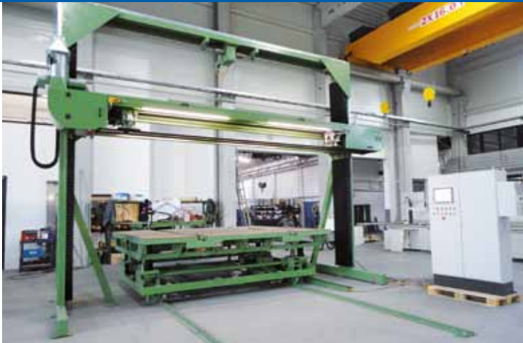
Vollautomatische Langbandschleifmaschine von Langzauner: mit Hubtisch zum Schleifen von Edelstahlblechen und -schweißkonstruktionen.
