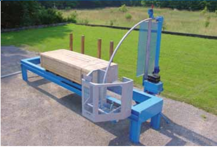
MOBILCUT Comfort: ein Modell mit hydraulischem Schneidvorschub und benutzerfreundlicher Joystick-Steuerung
