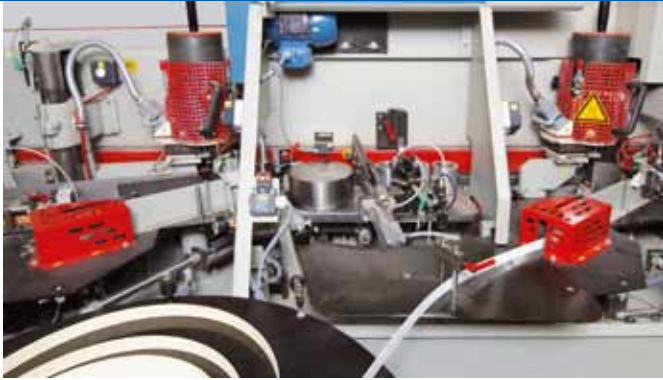
Das neuartige zweifache Verleimsystem „DUO-CombiMelt“ DUO-CombiMelt, the new dual-gluing system
